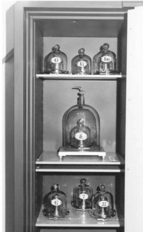
*El Prototipo Internacional del Kilogramo (centro), un cilindro de cinco centímetros de ancho hecho de platino e iridio, pasa sus días en el interior de tres tarros, cada uno dentro de otro, en el interior de una cámara de temperatura y humedad controladas, situada en París. Rodean al kilogramo seis copias oficiales, cada una dentro de dos tarros. (Reproducido con permiso de BIPM, que se reserva el derecho de copia internacional.)*
